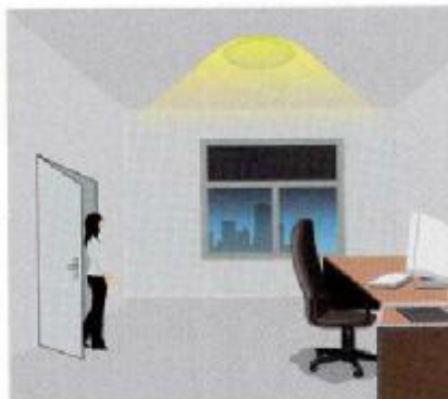
Bei Unterschreitung des eingestellten Lichtwertes löst der Bewegungsmelder eine Einschaltung aus.
