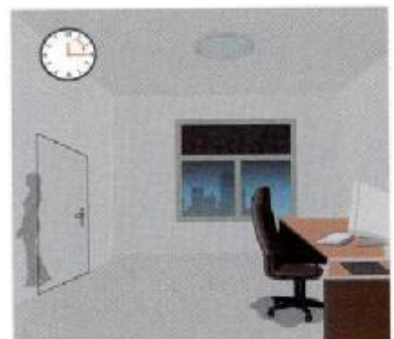
Nach der eingestellten Nachlaufzeit schaltet der Sensor den Verbraucher wieder aus, falls keine weitere Bewegung im Raum mehr festzustellen ist.
